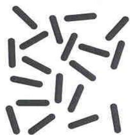
Rys. 3. Struktura izotropowa. Ciekły kryształ podgrzany do odpowiednio wysokiej temperatury traci swój porządek orientacyjny (patrz rys. 2) i powstaje wtedy zwykła klarowna ciecz o typowych własnościach.
